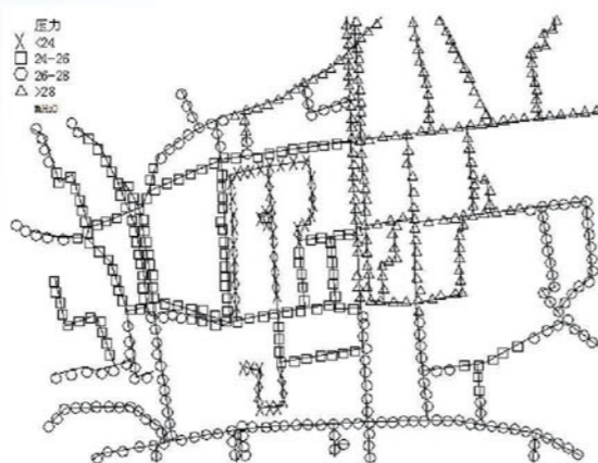
图5 HQ路北段施工管网压力
