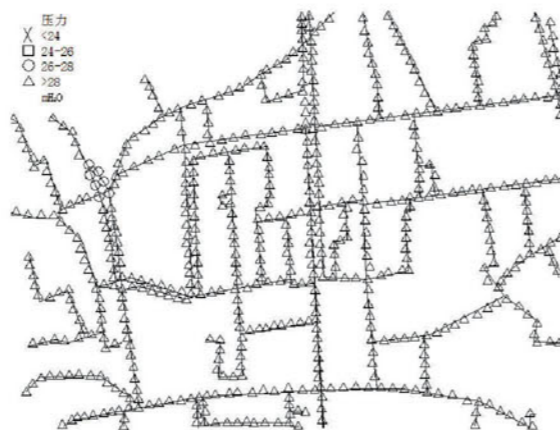
图6 HQ路南段施工管网压力
