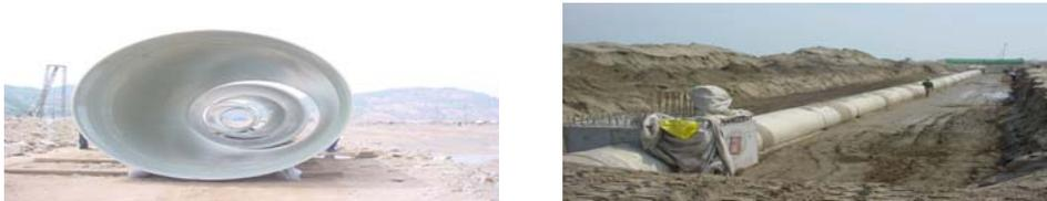
图 6-11 玻璃钢夹砂管实例
