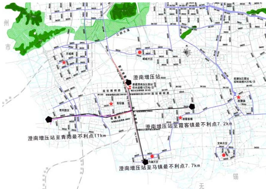
图 6-7 新建澄南加压站扬程计算示意图
